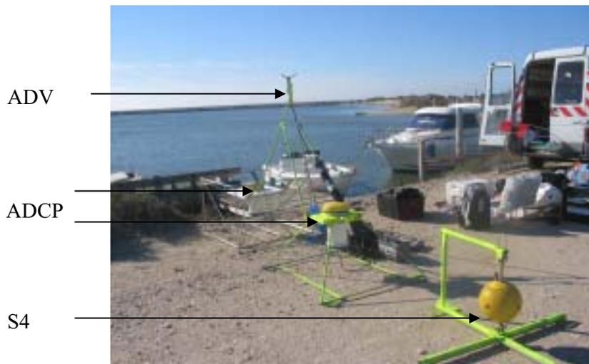
Figure III 12: Appareillage utilisé pour mesurer le courant
